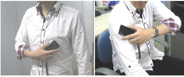
Figure 8 布上のデバイス位置情報に基づくウェアラブルインターフェースの概念図。
