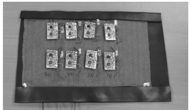
図 10 2次元電極アレイ試作システム（センサノード側） Fig. 10. A prototype system of a two dimensional electrode array (sensor nodes side).
